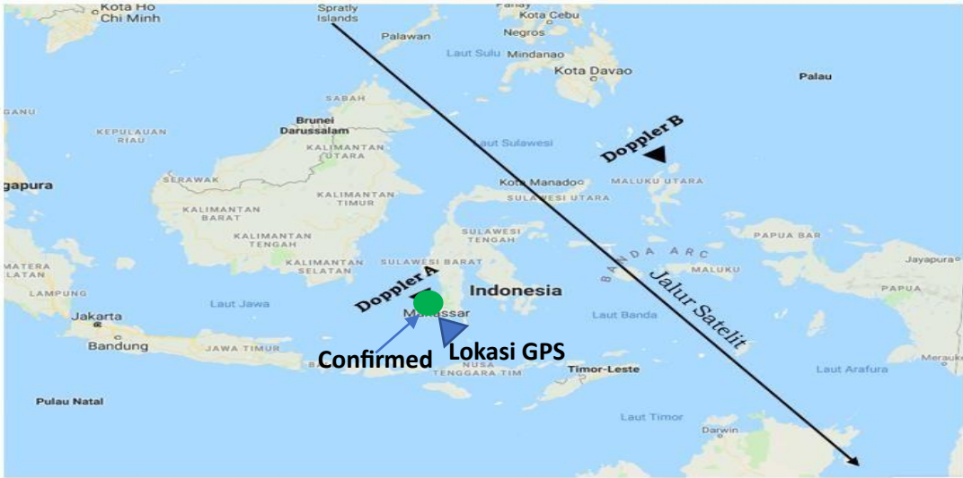
Gambar 3.7 Contoh Confirmed Alert hasil deteksi dari LEOSAR dengan data lokasi GPS
