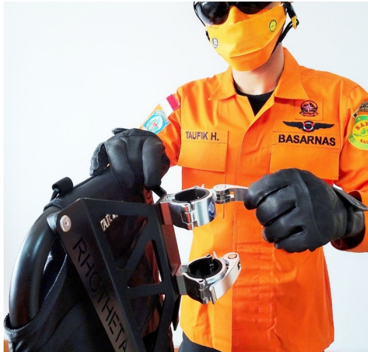
Gambar 4.17 Longgarkan kedua pengait antenna
