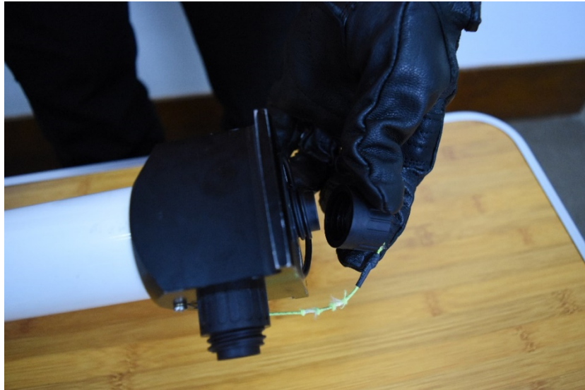
Gambar 3.14 Membuka penutup konektor antenna
