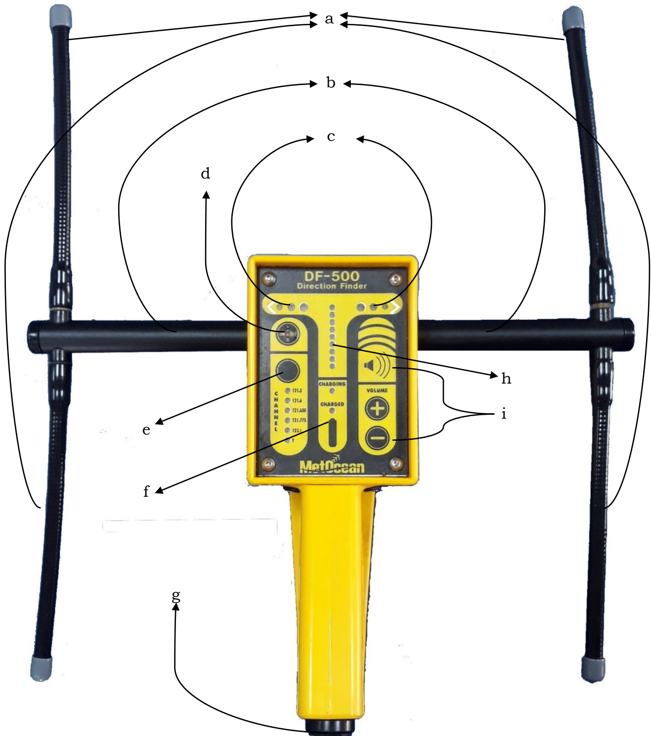
Gambar 2.2 Komponen-komponen luar radio pencari arah Met Ocean DF-500: (a) antena, (b) penyangga antena, (c) indikator arah, (d) tombol power dan tombol kecerahan, (e) tombol kanal/frekuensi, (f) indikator pengisian daya, (g) konektor pengisian daya atau konektor headset (h) indikator kekuatan sinyal, (i) pengaturan suara.
