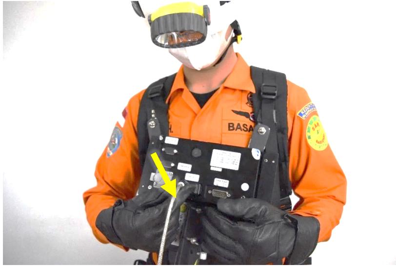
Gambar 3.26 Menyambungkan konektor D-Sub antenna dengan soket/ port konektor antenna pada DCU
