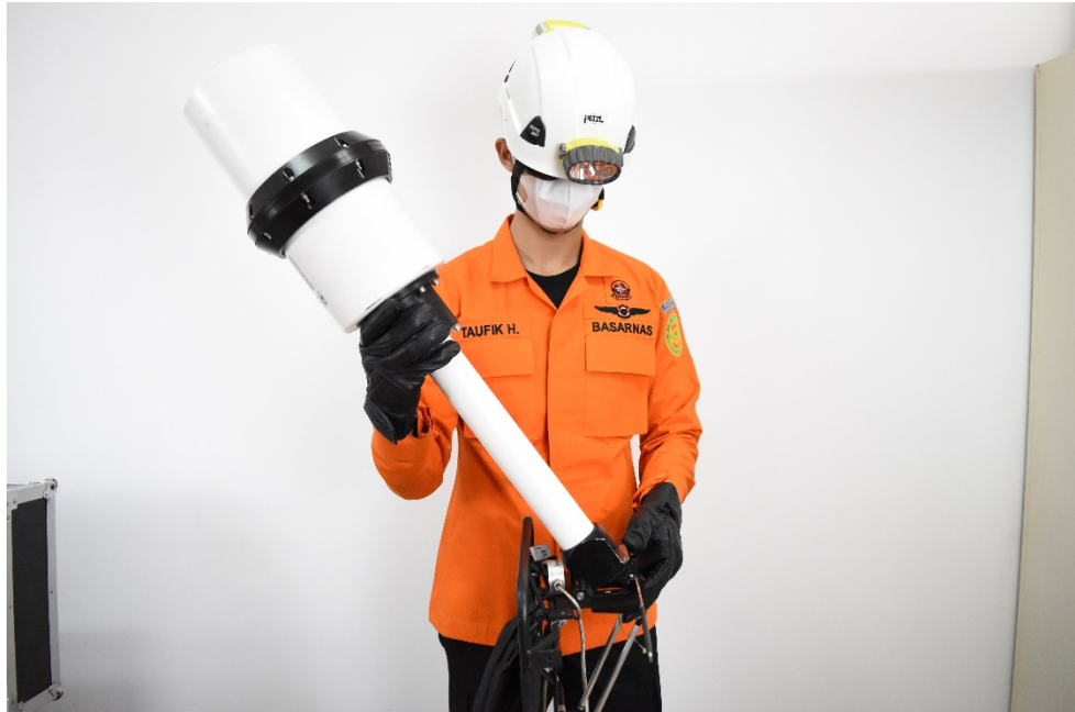
Gambar 3.16 Memasukan konektor antenna ke tempat yang disediakan, hingga terdengar bunyi klik
