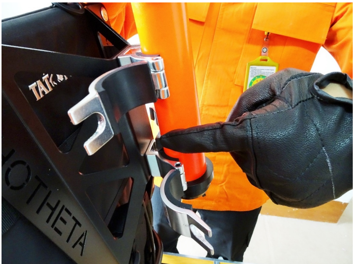
Gambar 4.18 Sesuaikan tanda hitam pada tiang antenna RT-400 dengan area yang tersedia di backpack Rhotheta RT-400
