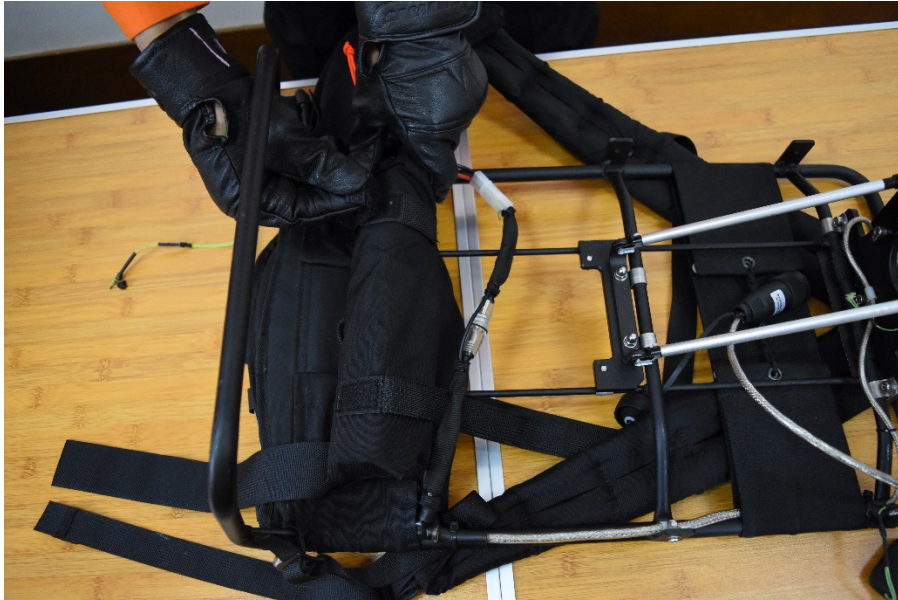
Gambar 3.12 Mengikatkan perekat tas baterai ke manpack
