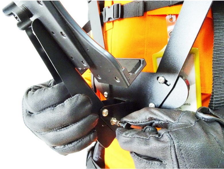
Gambar 4.23 Pengaturan penyangga tablet agar nyaman digunakan
