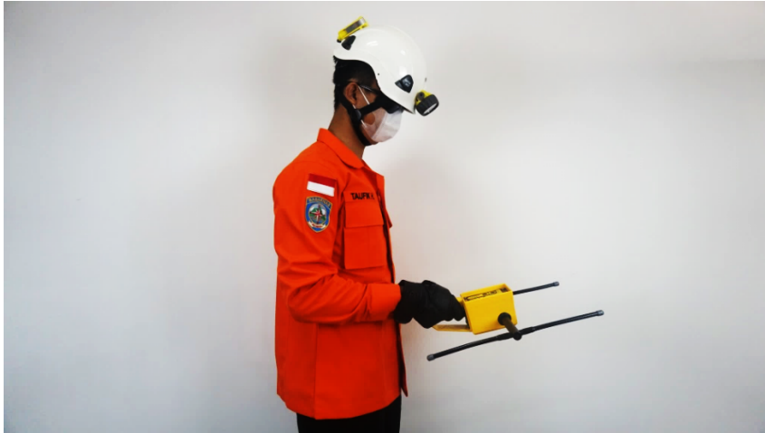
Gambar 2.9 Arahkan radio pencari arah Met Ocean DF-500 secara mendatar
