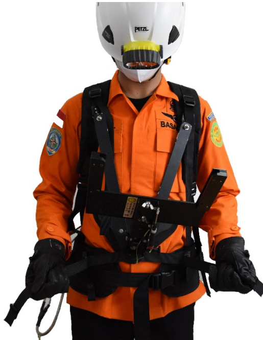
Gambar 3.23 Mengencangkan tali yang ada pada frame display unit
