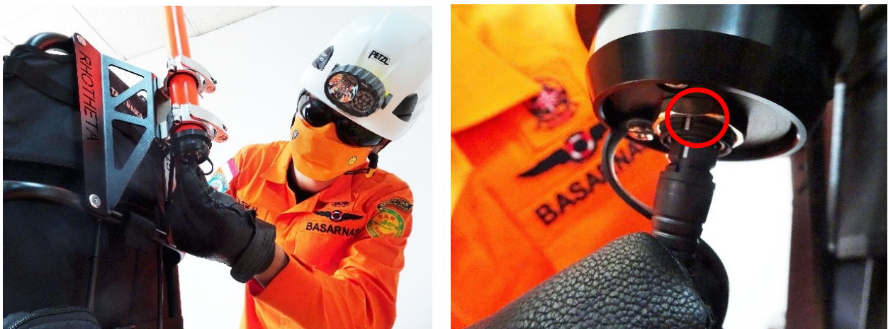
Gambar 4.20 Penyambungan konektor kabel antenna
