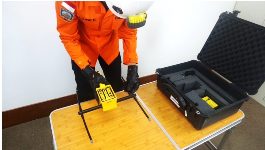
Gambar 2.5 Petugas memasang keempat antenna radio pencari arah Met Ocean DF-500
