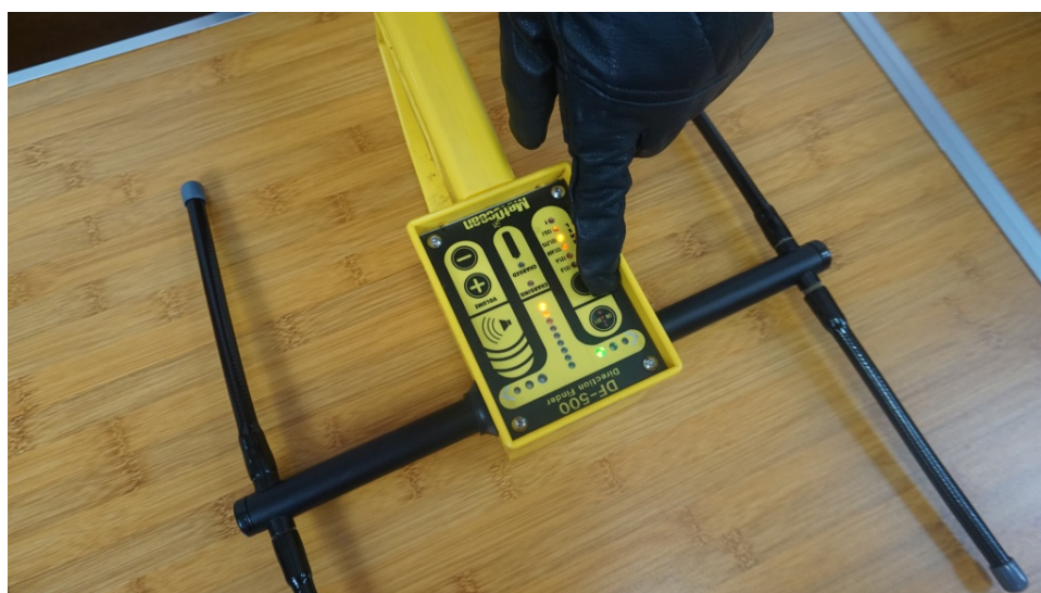
Gambar 2.8 Pilih frekuensi/kanal radio pencari arah Met Ocean
