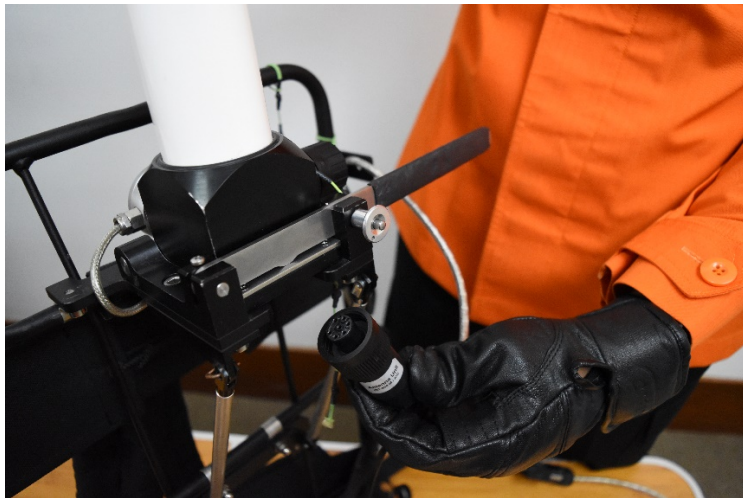
Gambar 3.19 Menyambungkan kabel konektor antenna dengan sistem antenna.
