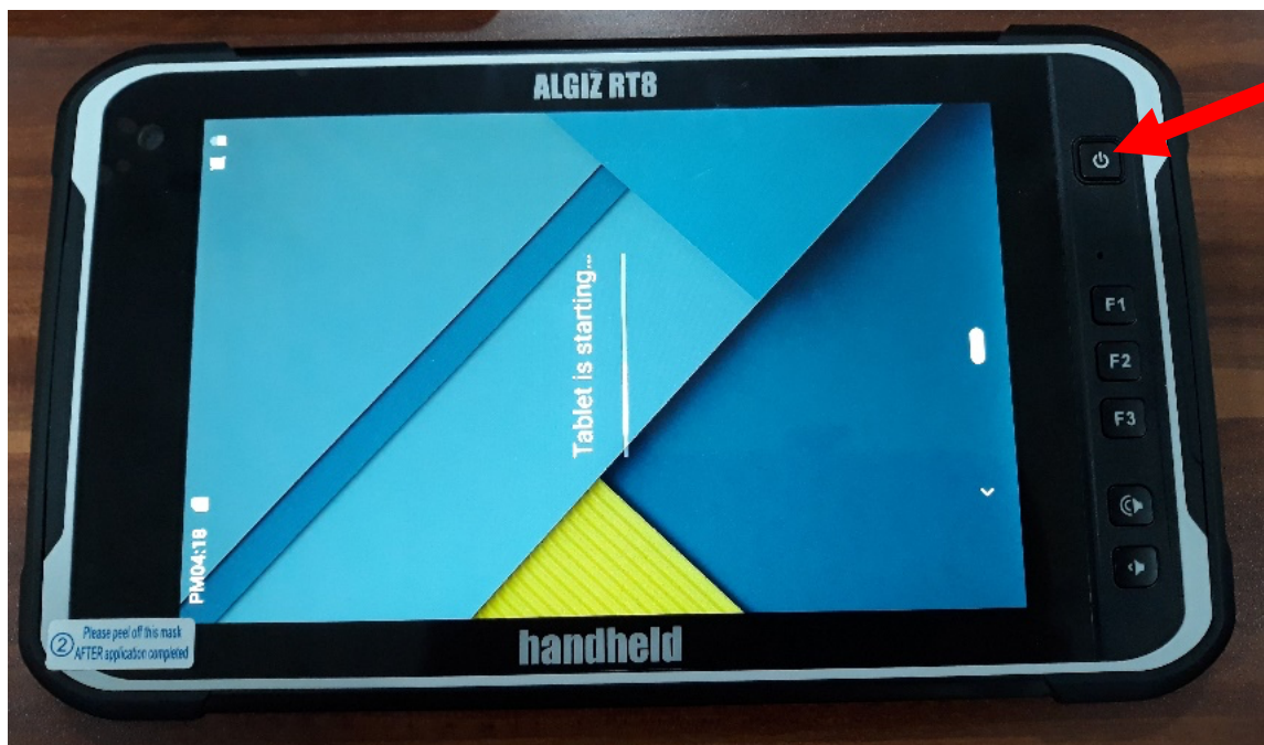
Gambar 4.26 Cara menghidupkan tablet DF-Scout
