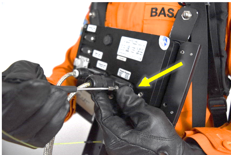
Gambar 3.29 Mengencangkan baut konektor D-Sub power pada soket/ port konektor power pada DCU
