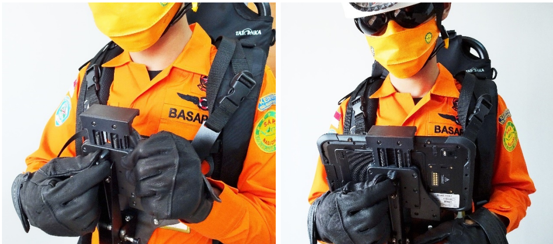
Gambar 4.24 Penyesuaian tinggi tablet DF-Scout
