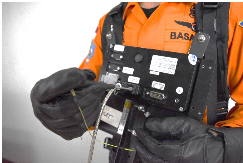
Gambar 3.27 Mengencangkan baut konektor D-Sub antenna pada soket/ port konektor antenna pada DCU
