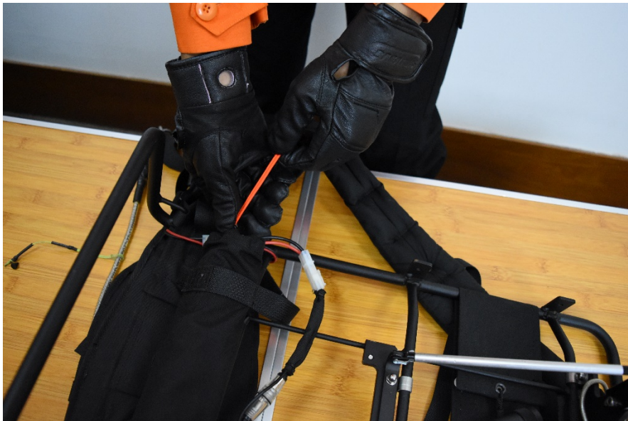
Gambar 3.11 Mengunci tas baterai
