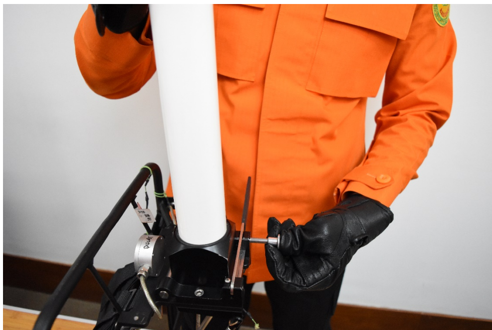
Gambar 3.17 Mengarahkan antenna menjadi vertikal
