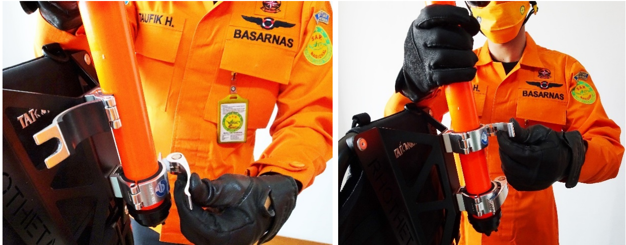
Gambar 4.19 Penguncian antenna RT-400 dari sisi bawah terlebih dahulu
