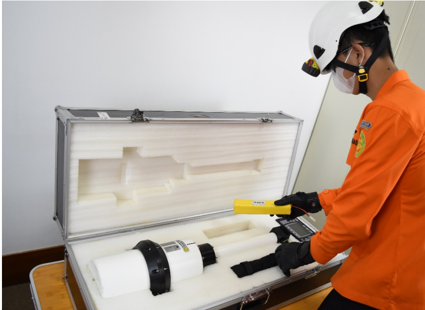
Gambar 3.10 Petugas membuka kotak radio pencari arah dan mengeluarkan baterai
