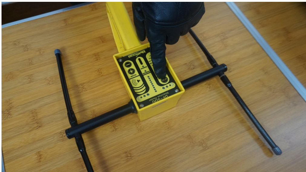
Gambar 2.6 Petugas menghidupkan radio pencari arah Met Ocean dan memeriksa kapasitas baterai
