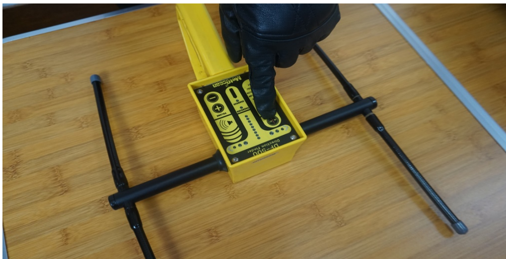
Gambar 2.10 Matikan radio pencari arah Met Ocean setelah pemancar Sinyal Mara Bahaya (suar) ditemukan
