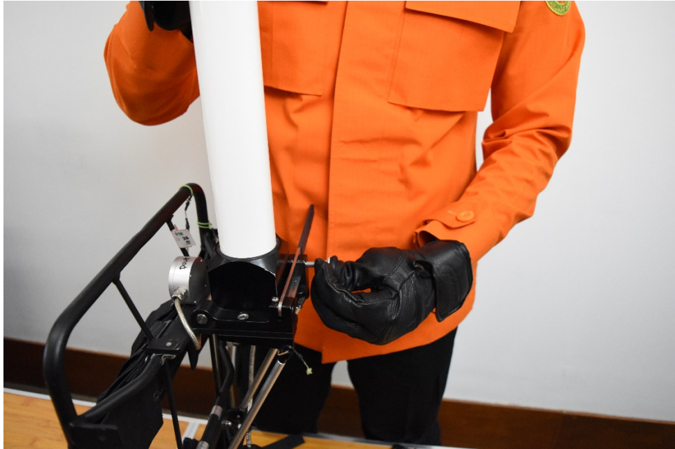
Gambar 3.18 Memasukkan pin untuk mengunci antenna
