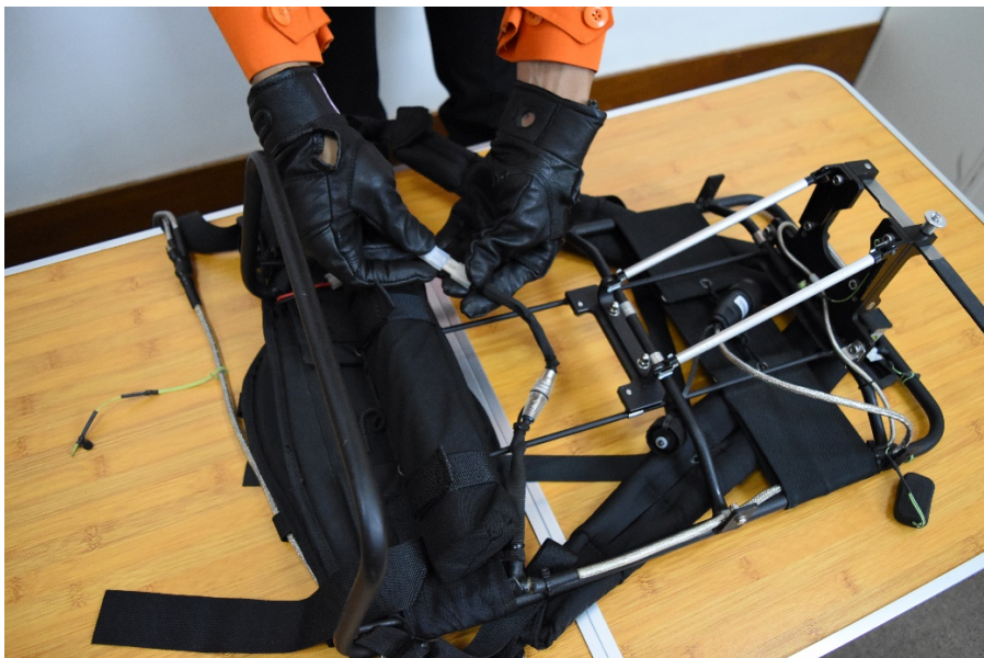
Gambar 3.13 Memasang baterai ke manpack serta menyambungkan konektornya.
