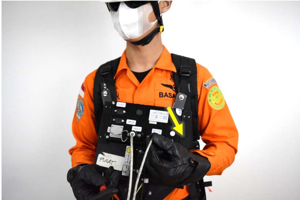
Gambar 3.28 Menyambungkan konektor D-Sub power dengan soket/ port konektor power pada DCU
