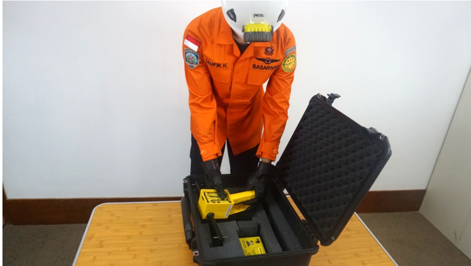
Gambar 2.3 Petugas mengeluarkan radio pencari arah Met Ocean DF-500 dari dalam kotaknya
