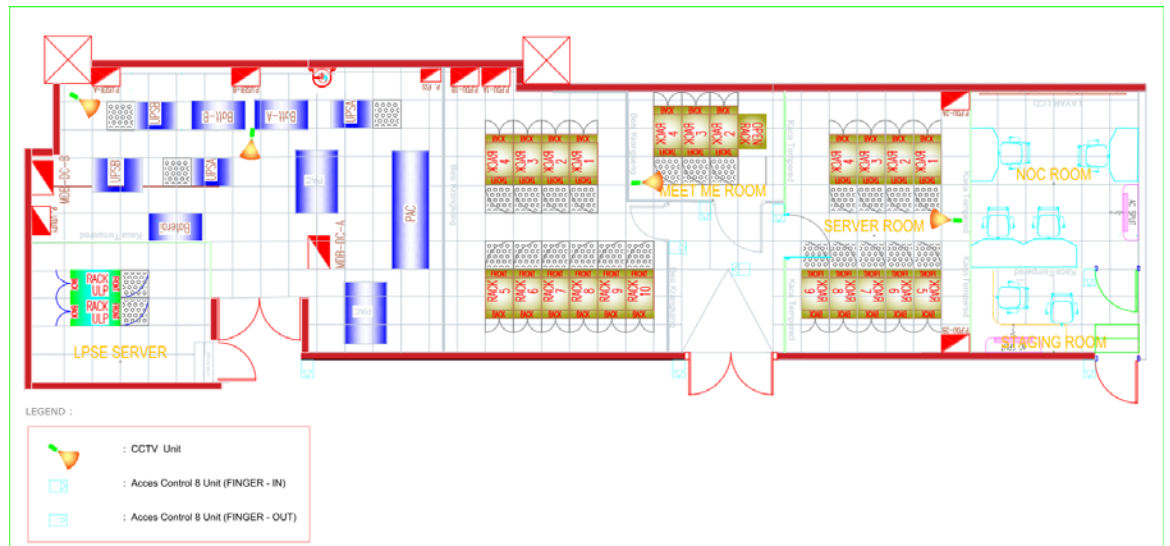
Gambar 6. Cctv dan ad dc
